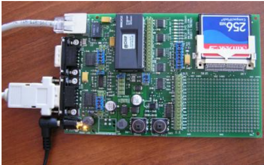
Рис.1 Подключение DK51 к ПК
